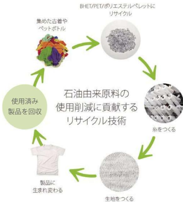
衣料品の約50%にはポリエステル繊維が使用され、年間4,500万トン以上が世界中で製造されており、多くの石油由来原料が使用されています。衣料品に含まれるポリエステル繊維を溶かし出し、精製して、もう一度ポリエステル繊維の原料であるポリエステル(PET)樹脂を製造するケミカルリサイクルの技術開発に成功しました。この技術で、衣料品に使われる石油資源の使用量を減らしていくことを目指します。
